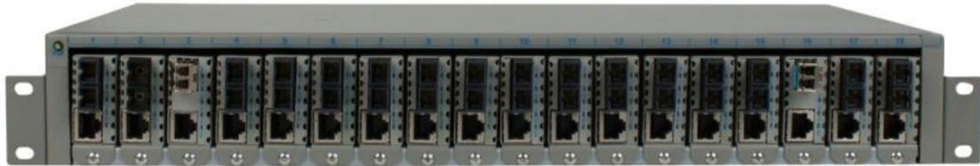
miConverter 18M 電源シャーシは、miConverterシリーズの小型メディアコンバータ製品に対応し、費用対効果に優れたラックマウントと電源ソリューションを提供します。このコンパクトなシャーシは、ラックマウント構造で、高密度で複数のメディアコンバータを統合するために理想的なシャーシです。サービスプロバイダ、エンタープライズあるいは公官庁向けで、UTPのスイッチ装置から光ファイバリンクを分配して接続するようなアプリケーションを展開させることができます。
