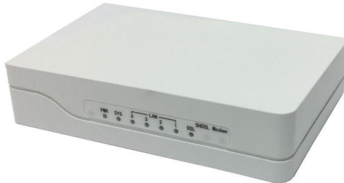
SHDSL(シングルペア ハイビットレート デジタル加入者線)ルーターであるAH505Rは、2つのLANネットワーク間の接続のために銅線を介して最大15Mbps /ペア(TC-PAM 128)の帯域幅でブロードバンド伝送を提供します。AH505Rルーターは、EFMモード、またはATMモードで動作します。また、EFMモードでビジネスクラスのイーサネットサービスを拡張し、DSLAMとの互換性を提供するように設計されています。
