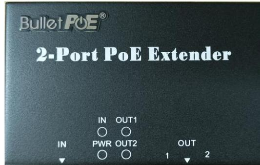
PE102 はイーサネットネットワークの範囲を合計 200 メートルまで拡張する、Power over Ethernet の設備です。100 メートルを超えるイーサネットネットワーク範囲を延長するコスト効率の良い方法で、WLAN アクセスポイントやネットワークカメラなどのネットワークデバイスにデータと電力を 200 メートルまで提供します。IEEE 802.3at/af PoE および Fast Ethernet データ基準に準拠しています。
