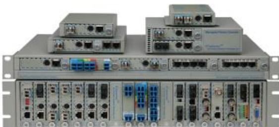
iConverter GX/Fモジュールは、ホットスワップに対応しており、19M（2U）または5M（1U）のラックマウント可能なシャーシ（19インチまたは23インチ）へ搭載可能です。シャーシには、AC電源、24VDCまたは48VDC電源などの電源を自由に組み合わせることができ、冗長構成が可能です。また1M（ACまたはDC電源）および2Mシャーシ（ACまたは18-60VDC電源）で使用することもできます。
