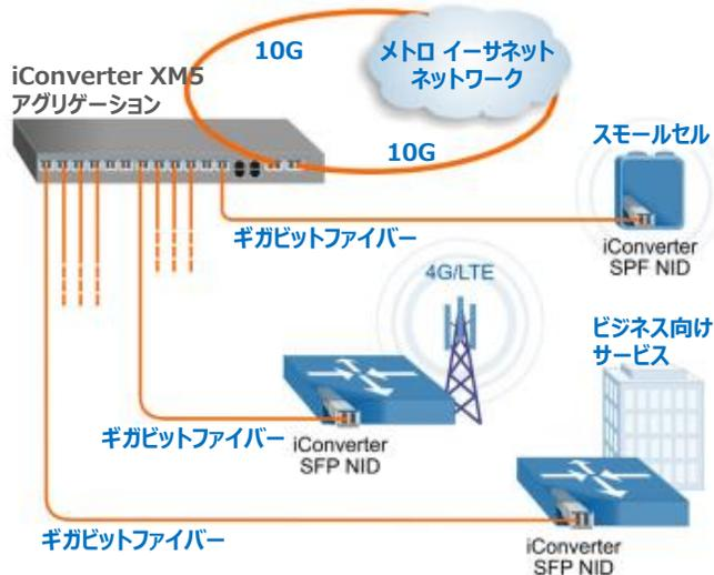
このアプリケーション例では、サービスプロバイダがスモールセル（小型の携帯基地局）、マイクロセルおよびビジネス向けサービスへどのようにパフォーマンスモニタリングと障害管理の機能を追加しているかを示しています。
