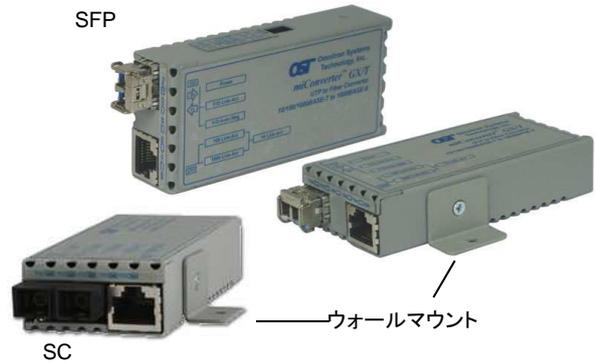
miConverter GX/Tでは、10/100/1000BASE-Tと1000BASE-Xを変換する小型メディアコンバータで、DIPスイッチによりリンクモードの制御ができます。SFP対応モデルも登場し、SFPを交換することにより、様々なファイバ仕様に対応します。また、ワイドレンジ温度対応で-40~+60°C(ACは-20°C~)、拡張温度-40~75°C(ACは-20°C~)、産業-40~80°C(DC電源のみ)と幅広い温度環境にも対応します。
