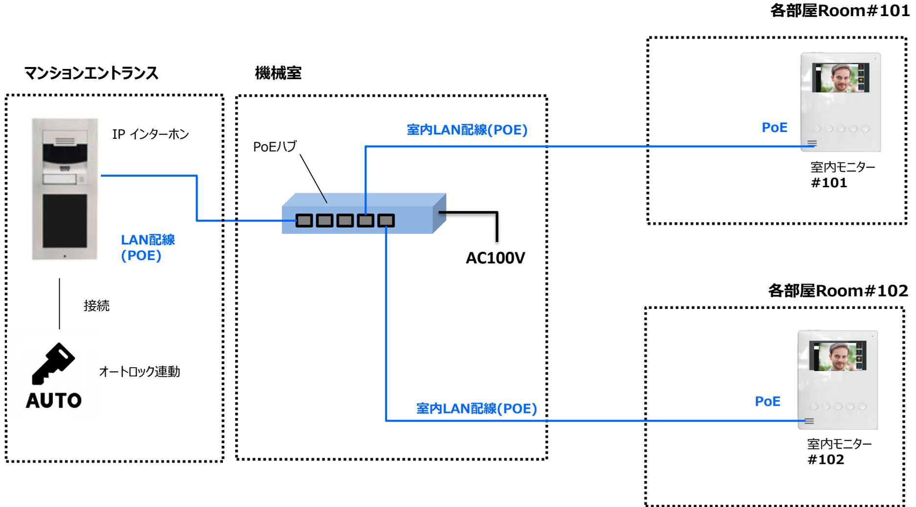
PoEハブにIPインターホンと各部屋の室内モニターを接続。IPインターホンから各室内モニターへの呼び出し、室内モニターからエントランスのオートロック解錠操作が可能。
