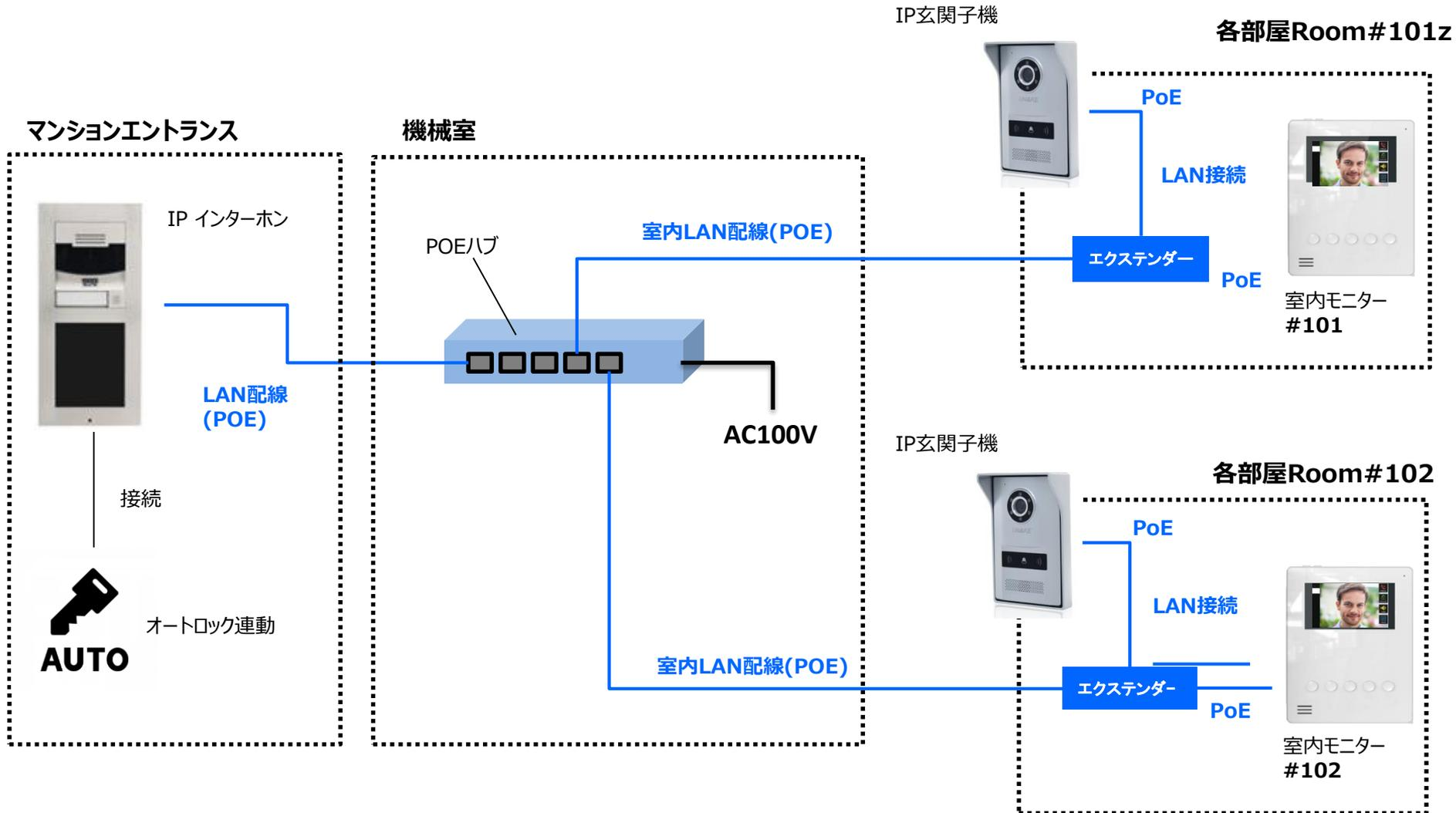
PoEハブにIPインターホンを接続。また、各部屋のPoEエクステンダーを介し、室内モニター、玄関子機を接続。IPインターホンから各室内モニターの呼び出し、室内モニターからエントランスのオートロック解錠操作が可能。また、玄関子機から室内モニターの呼び出しが可能。
