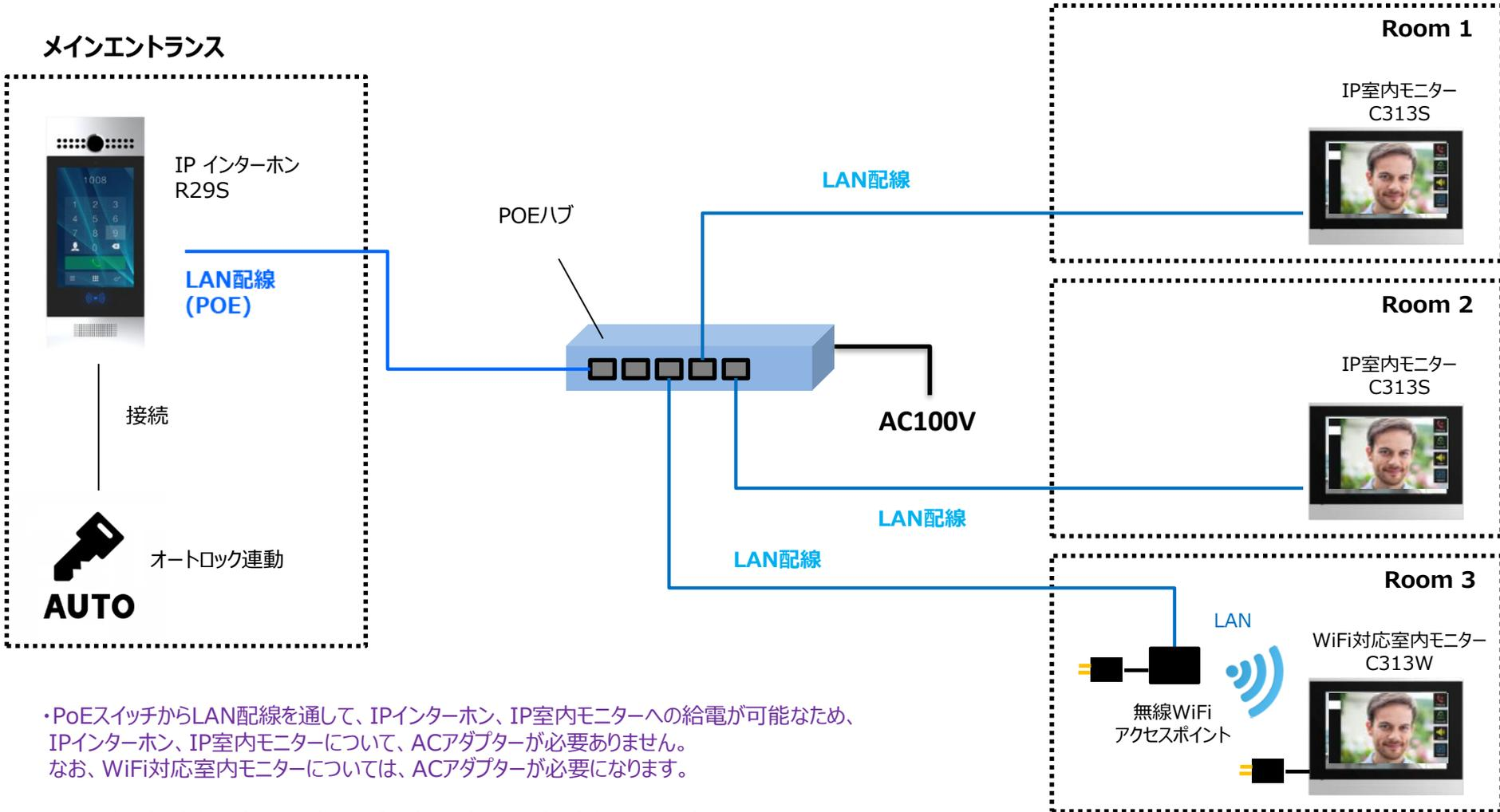
・PoEスイッチからLAN配線を通して、IPインターホン、IP室内モニターへの給電が可能のため、IPインターホン、IP室内モニターについて、ACアダプターが必要ありません。
