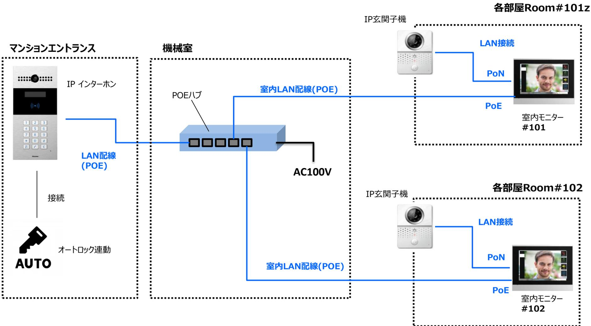
PoEハブにIPインターホンと各部屋の室内モニターを接続。IPインターホンから各室内モニターの呼び出し、室内モニターからエントランスのオートロック解錠操作が可能。
